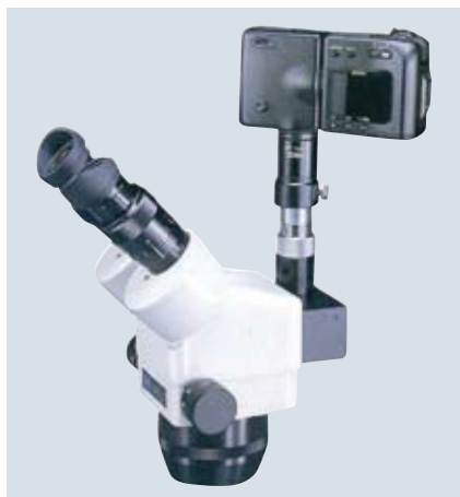
Камера Nikon Coolpix 950 на EMZ-8TR через адаптер MA151/30/50
